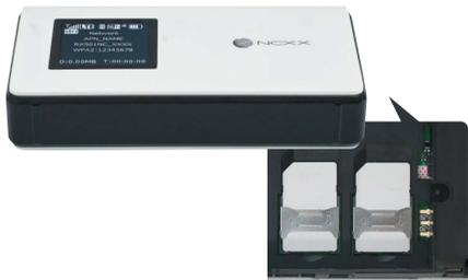
2つのSIMスロットを有し、1台の端末で任意に回線を切り替えることができる。料金プランや利用エリアによって、最適なサービスを選択することが可能となる。
