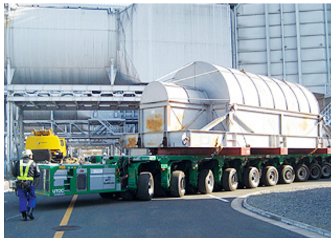
火力発電所用発電機器の輸送
