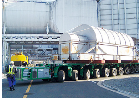
火力発電所用発電機器の輸送
