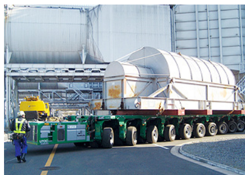
火力発電所用発電機器の輸送
