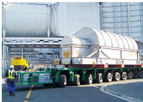
火力発電所用発電機器の輸送
