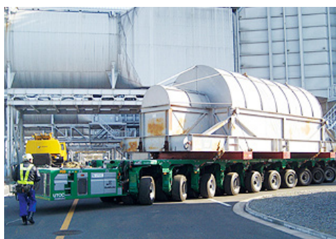
火力発電所用発電機器の輸送
