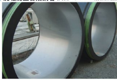
洗堀防止合成鋼管 (内面ステンレス鋼板配置)
