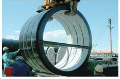
短尺管を組み合わせて出荷可能
