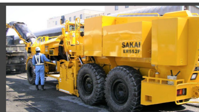
ロードカッター 道路補修工事に使用 傷んだ既設路面を幅2m/深さ15cmで切削する
