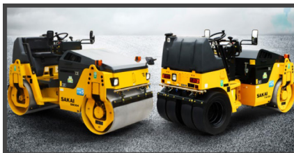
タンデムローラ(左)・コンパインドローラ(右) 市街地の中小型舗装工事で使用
