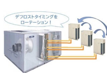
「デフロストローテーション」 搭載のヒートポンプ AHU
