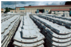
東京外環道の コンクリートセグメント
