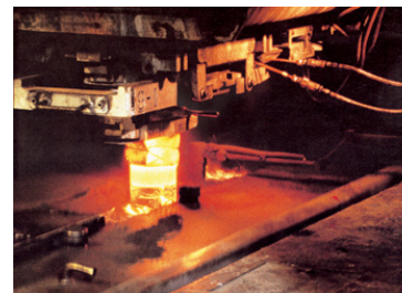
連続鑄造工程
